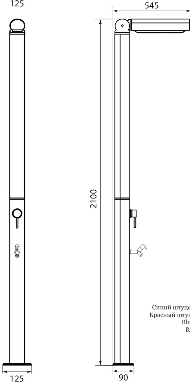
Подключение к водопроводу сбоку
