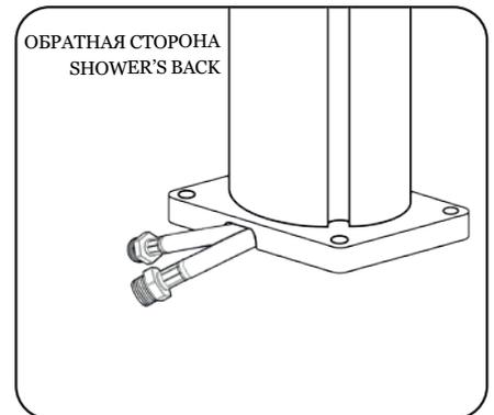
Подключение к водопроводу снизу
